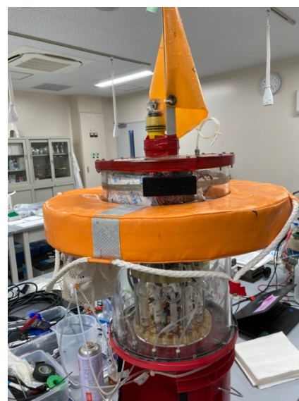
図 1. 浮体に組み込まれた eDNA サンプラー
