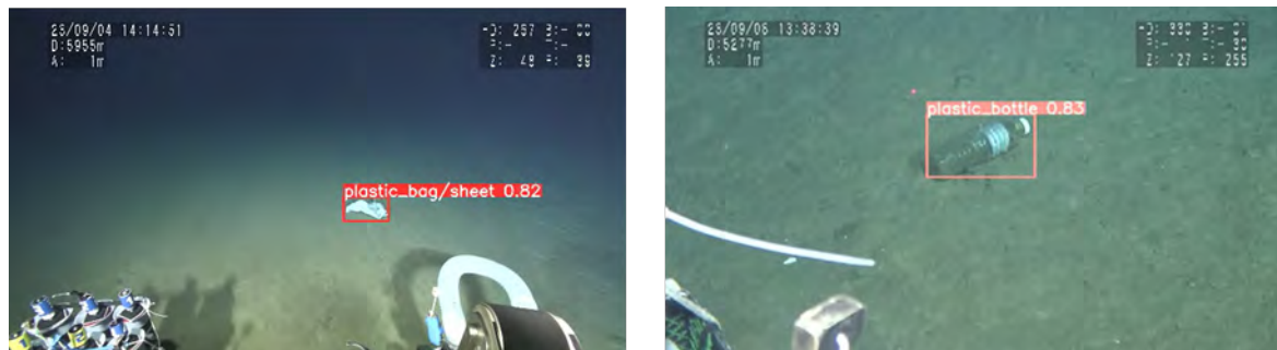
図. 学習済みの深層学習モデルによるプラスチックごみ検出結果
