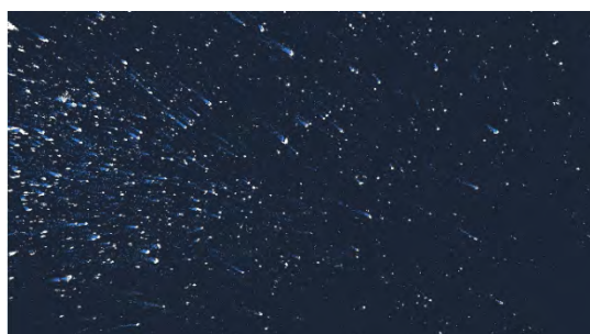
EVS で測定された浮遊する粒子の高速撮影動画のスクリーンショット。
