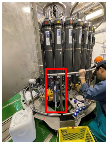
図1. 「みらい」のCTDフレームに取り付けた採水用殺菌装置(赤枠内)
