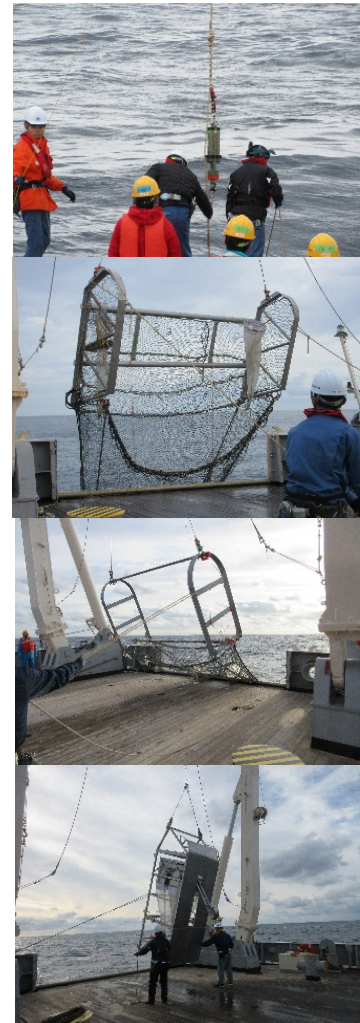
白鳳丸での船上作業。上から係留系回収、4m ビームトロール、3m Agassiz 型ビームトロール、深海用そりネット
