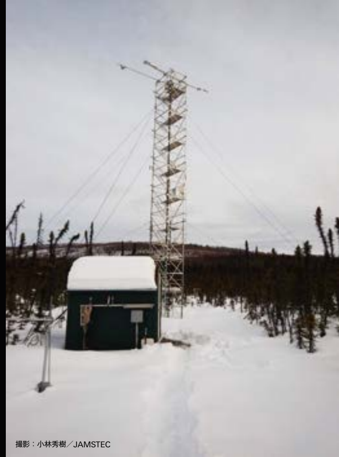
アラスカにあるポーカーフラットリサーチレンジ（PFRR）フラックス観測スーパーサイト。高さ17mのフラックス観測タワーを中心に、周囲の針葉樹林帯に設置した観測機器で構成されている。北極域の気象や温室効果ガスが大気中へ出入りする量（フラックス）、植物の季節変化などを観測する。【地球環境部門】
