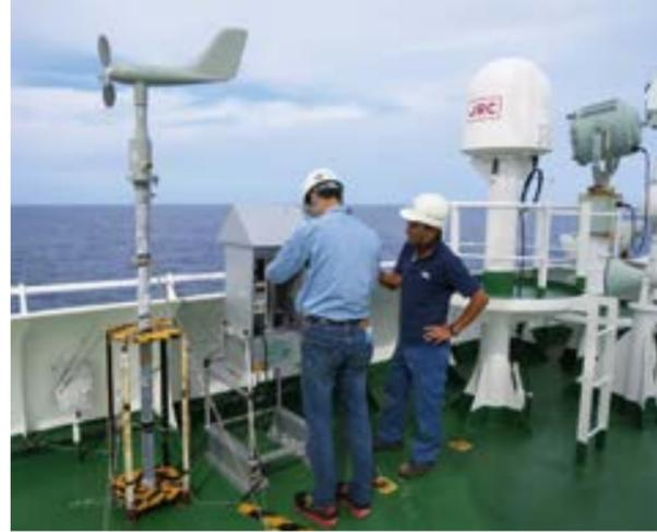
コンパステッキと呼ばれる船の屋上に設置されたエアサンプラーのフィルターを交換する竹谷さん(左)。自船の煙を捕集してしまわないように、船の前方からの風の場合のみポンプの吸引を行うように風向風速計と連動する仕組みになっている。
