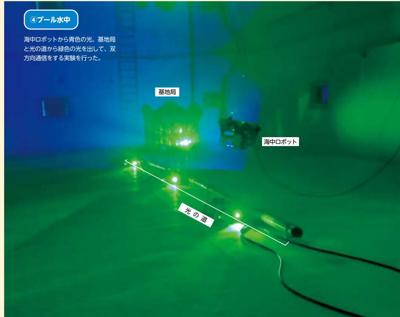
用と、受信用の光ファイバー先端部が所々に取り付けられている (②)。光ファイバー先端部が光Wi-Fiのアンテナの役目をする。澤さんらは、それらを「光の道」と呼んでいる。
