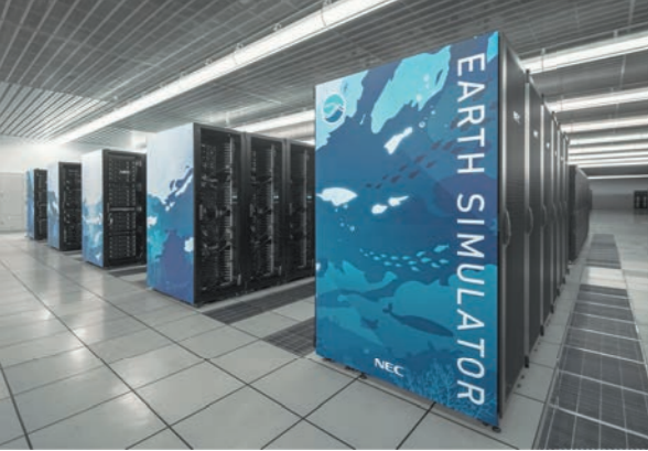
地球シミュレータ 「地球シミュレータ」はベクトル・スカラー型のスーパーコンピュータです。特に海洋や大気、エコシステム、海水などの環境のシミュレーションに適しています。
