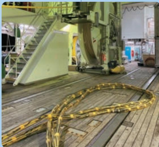
船尾から曳航するストリーマケーブル。ケーブルに取り付けられた多数の水中マイクでエアガンの信号を受振します。
