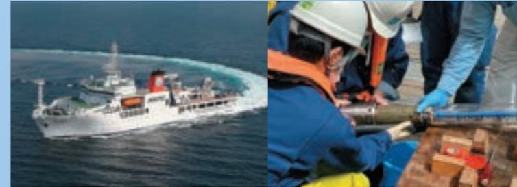
海底広域研究船「かいめい」金属製の筒(ピストンコアラ)を海底へ突き刺して、海底下の地層を採取します。
