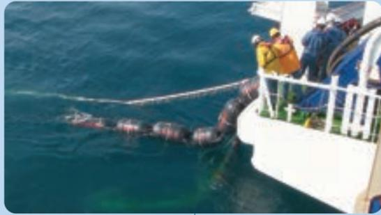
海底下構造探査中、エアガンから定期的に海中に圧搾空気が放出されて、地震波として伝わっていきます。
