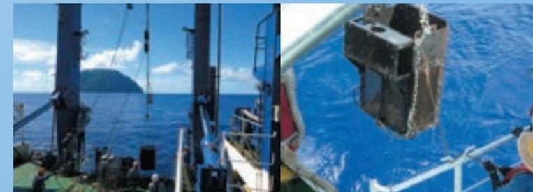
ドレッジャーによる底引きで海底の岩石を採取します。
