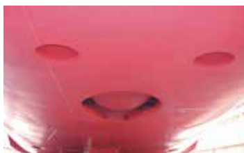
船底部の音響航法装置の送波器(手前の2つ)と水中通話機の格納式のソーナードーム
