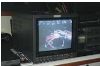
音響画像伝送装置により、「しんかい6500」のカメラがとらえた映像が静止画として船上に送られる
