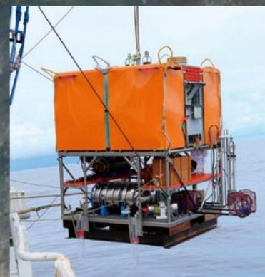
海底設置型観測システム「FFC11K」。FFCはフリーフォールカメラシステムの略で、11Kは最大潜航深度が11,000mであることを意味する。海面から自由落下して着底し、海底の撮影や試料の採取などを行う。通常は「FFC11K」を回収するまで海底の情報は分からないが、音響通信装置を搭載することで画像を母船に転送し、船上で確認できる。
