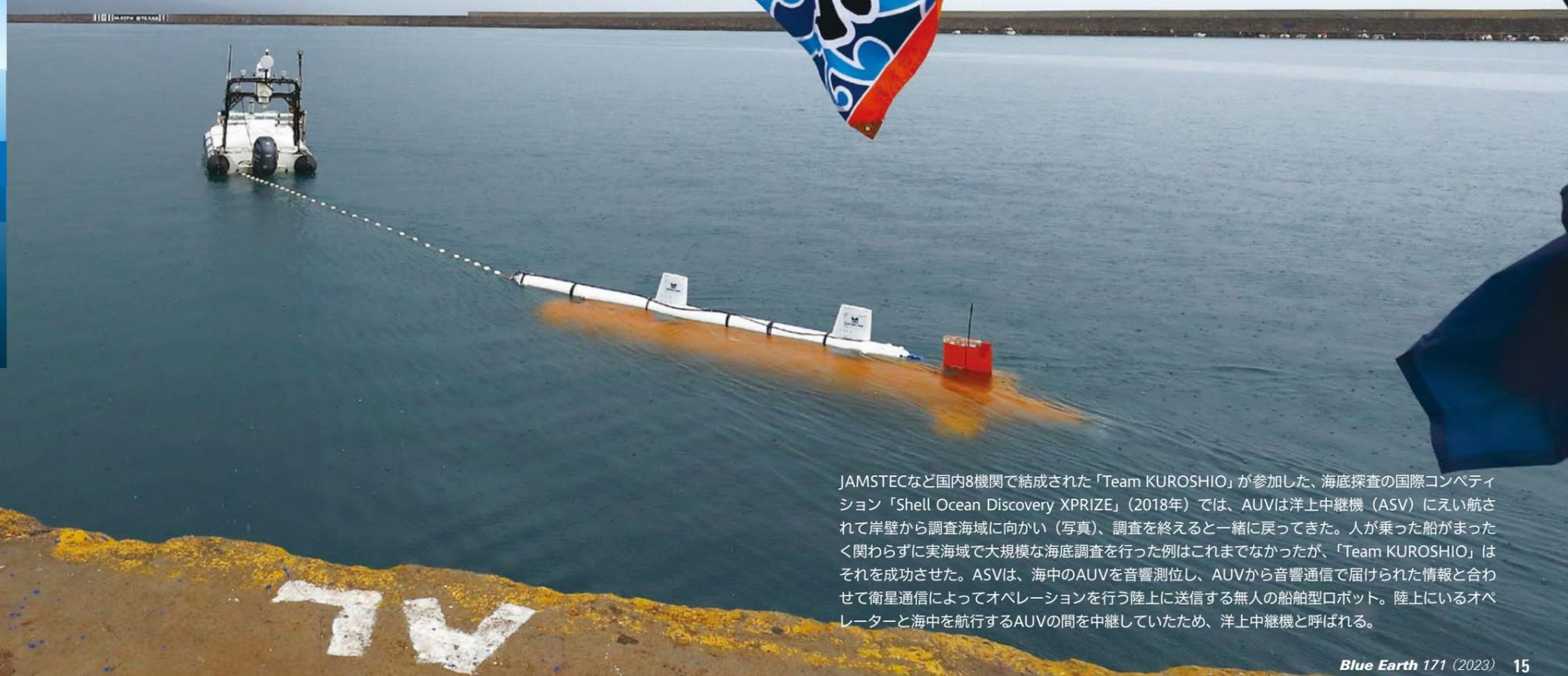
JAMSTECなど国内8機関で結成された「Team KUROSHIO」が参加した、海底探査の国際コンペティション「Shell Ocean Discovery XPRIZE」（2018年）では、AUVは洋上中継機（ASV）にえい航されて岸壁から調査海域に向かい（写真）、調査を終えると一緒に戻ってきた。人が乗った船がまったく関わらずに実海域で大規模な海底調査を行った例はこれまでなかったが、「Team KUROSHIO」はそれを成功させた。ASVは、海中のAUVを音響測位し、AUVから音響通信で届けられた情報と合わせて衛星通信によってオペレーションを行う陸上へ送信する無人の船舶型ロボット。陸上にいるオペレーターと海中を航行するAUVの間を中継していたため、洋上中継機と呼ばれる。
