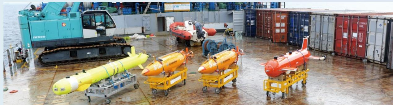
隊列制御試験を行った性能とメーカーが異なる4機のAUV。右から国立研究開発法人海上・港湾・航空技術研究所海上技術安全研究所のNMRI航行型AUV2号機、3号機、4号機、株式会社IHIのAU3。ASVには「KaiKoo（かいこう）」を使用した。
