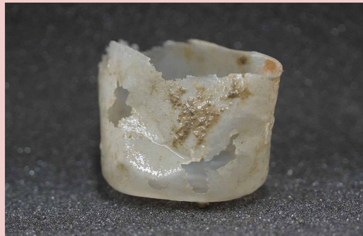
深海に半年間放置されたセルロース製のコップ。プラスチックとは違い、微生物による分解がしっかりと進んでいるのがわかる。 (協力：NEDO、写真提供：磯部紀之、JAMSTEC)
