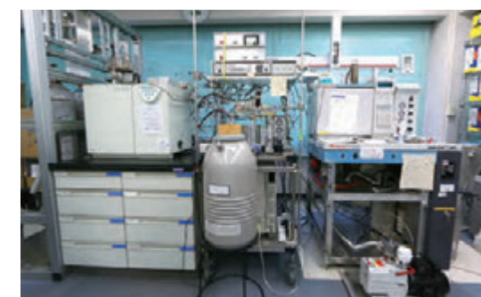
世界で最も微量試料の同位体測定が可能な nano EA(元素分析計)/IRMS(同位体質量分析計)
