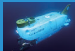
有人潜水調査船 「しんかい6500」 最大潜航深度 : 6,500m 乗 員 数 : 3名 全 長 : 9.7m 空 中 重 量 : 26.7トン
