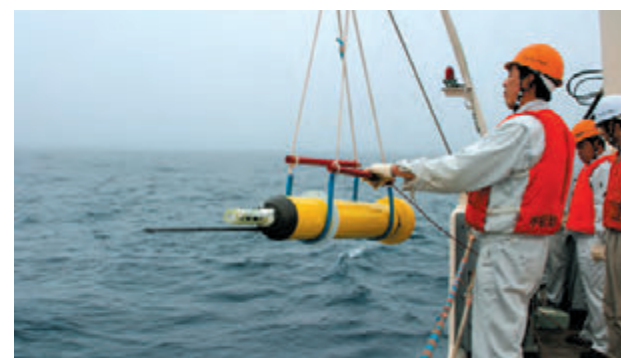
水温、塩分、圧力を自動で観測できるロボット「アルゴフロート」の投入
