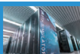
地球シミュレータ (横浜研究所) 総 演 算 性 能 : 19.5 PFLOPS 総 メ モ リ 容 量 : 556.5 TiB 共有ストレージ容量 : 61.4 PB ノード間ネットワーク帯域 : 200 Gb/s (双方向)
