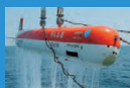
深海巡航探査機 「うらしま」 最大潜航深度 : 3,500m 全 長 : 10.7m 空 中 重 量 : 7.0トン
