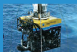
無人探査機 「ハイパードルフィン」 最大潜航深度 : 4,500m 全 長 : 3.0m 空 中 重 量 : 4.3トン
