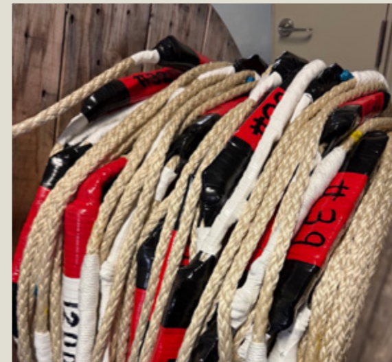
写真上は、長期孔内計測装置がついたロープの長さを調整している様子。下は、約900mのロープにつなげた128個の測定装置。
