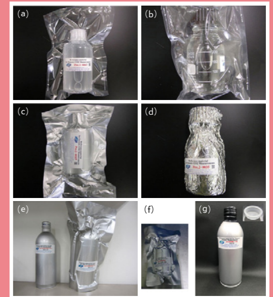
内田氏の研究チームが開発した海水標準物質。使用する素材を変えて試作を重ね、アルミ缶を使用した最終的な形状(g)にたどり着いたという。
