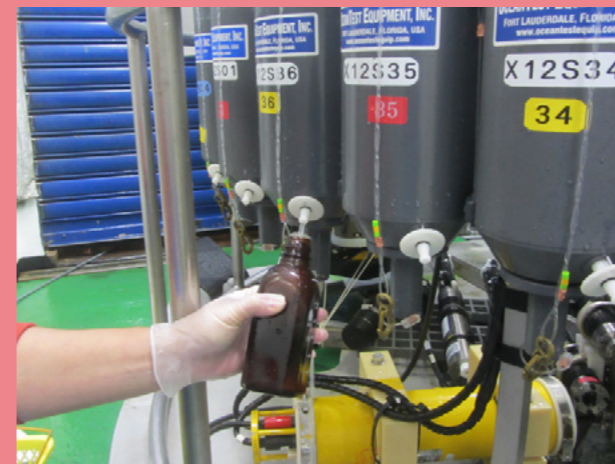
採水器で採水した海水をボトルに採っている様子。その後、採水した海水の塩分を精密に測定し、センサーで計測した塩分を高精度で補正する(2025年の「みらい」航海より)。
