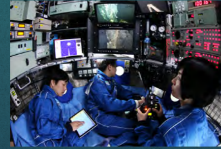
水深6500mまで潜ることができる有人潜水調査船。音波を用いることで、船体周辺の海底地形や自船位置の確認や、支援母船「よこすか」との水中通話が可能。また、船外のカメラで撮影した画像を高速音響通信で「よこすか」に伝送できるため、船上にいながら海中の様子を知ることができる。
