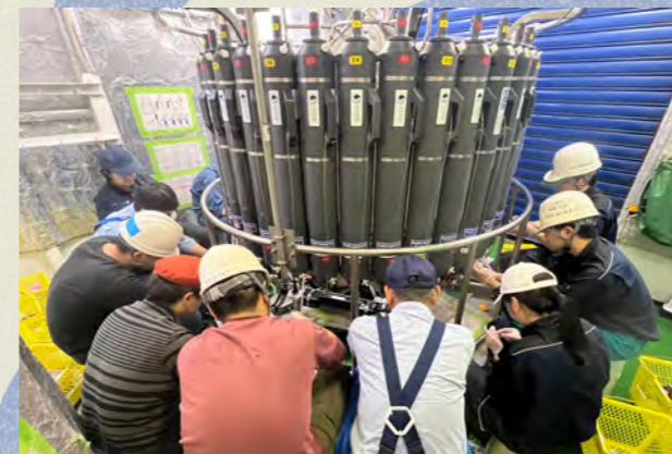
CTD採水器から採水する研究者たち。さまざまな水深から中央灰色のニスキンボトに採取した海水を、塩分や栄養塩、微生物などの分析用に専用容器へ分取する。その海水を精密に、厳密に分析すると、海洋の大循環や地球環境変動、それに伴う微生物生態系の変動などを描き出すことができる。
