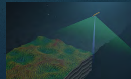
海底付近から観測を行うことで、高解像度の海底地形や海底下構造データを取得できる自律型無人探査機。2022年から8000m級への改造を開始し、2025年7月には深度8000mの航行試験に成功。また、拓洋第3海山や日本海溝においても試験潜航を実施し、高解像度の地形観測も実現している。
