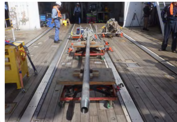
2023年11月の航海調査で、西之島周辺の海域でピストンコアラーを用いて海底堆積物のコア試料を採取したときの様子。西之島北側の沖で採取した約1.5mのコアは、一様に黒い火山灰で、2020年の噴火で大量に放出されたものと考えられる。
