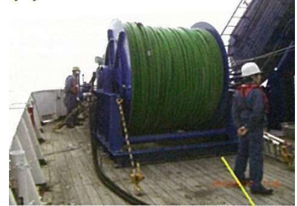
写真-3 ストリーマーケーブル
