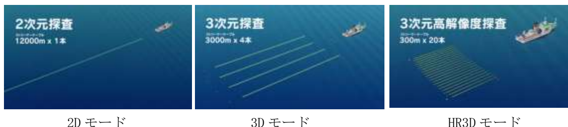
図-3 3モード対応探査装置
