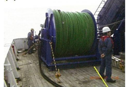
写真-3 ストリーマーケーブル
