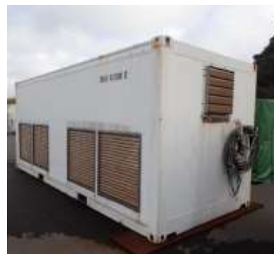
写真-1 20ft コンテナ型コンプレッサー
