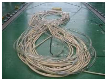
写真-4 ストリーマーケーブル
