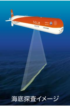
1998年に実験機として開発され、さまざまな試験や改造を重ね、2009年に実用機として生まれ変わった自律型無人探査機です。大きなペイロード区画を有し、大型の調査機器も搭載可能です。機体に内蔵するコンピュータに入力した調査シナリオに従って自律航行します。
