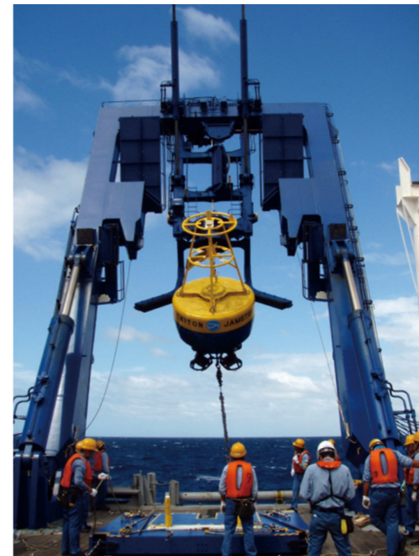
図1 TRITONブイ吊り上げの様子
