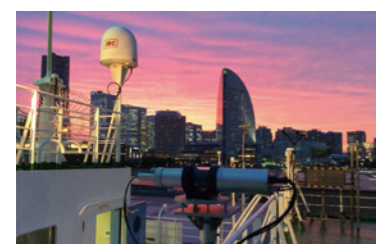
図1 小型化したMAX-DOAS受光部、横浜の夕暮れと共に。
