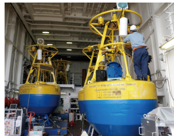
図10 「みらい」船上で整備中のTRITONブイ
