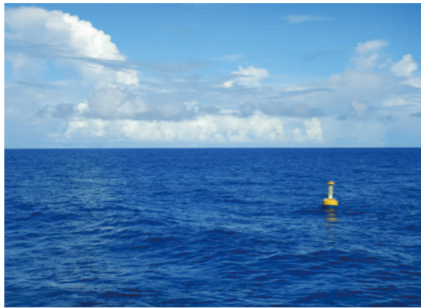
図8 暖水プール北端付近のPHSMO測点に設置した係留ブイ
