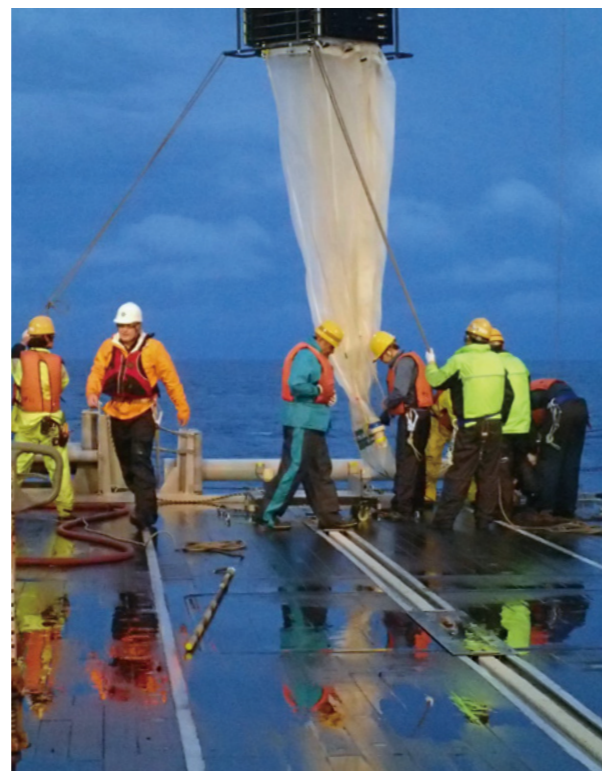
図2 鉛直曳き多層式プランクトンネット（VMPS）での試料採取 (MR17-03C)
