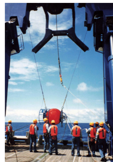
図2 MR00-K07 Leg 2での中層ADCP係留系の設置作業風景
