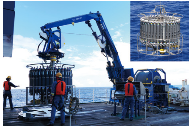
図3 CTD観測装置がウインチを使って海中から揚収されている様子。装置の下部にセンサー類、上部にニスキンボトル36本が取り付けられている(右上図)。ウインチはBEAGLE2003用に新たに導入されたもの。
