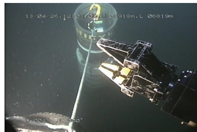
▲「かいこう7000II」のブークルから見た「ちきゅう」による掘削孔と長期孔内観測装置の上部
