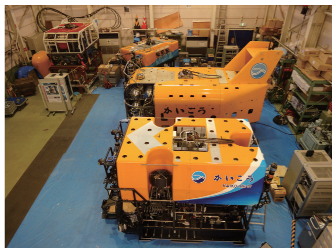
▲大深度無人探査機勢揃い（一番奥から「ABISMO」、「かいこう7000II」、「かいこう」ランチャー、「かいこうMk-IV」）
