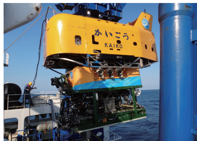
▲「かいこう7000II」。上の部分がランチャー、下の部分がブークル（子機）
