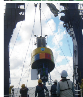
図1 低周波音源(500Hz)の係留作業(上)、津波ブイ投入作業(下)
