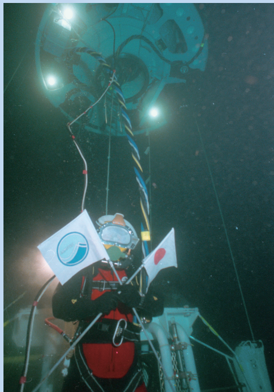
▲水深300mの海底に降り立ったダイバー（上は水中エレベーターSDC）
