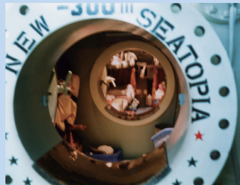
▲DDCは、ダイバーを加圧・減圧する居住区画で、ベッドやシャワー、トイレなどの設備が設けられていた。
