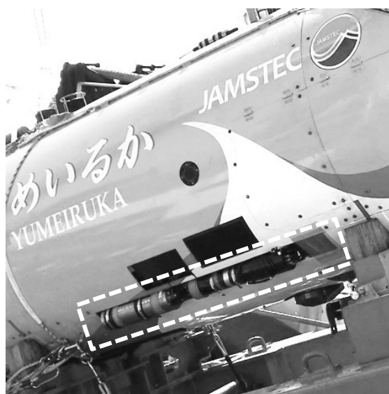
図3 ゆめいるかに搭載された現場型 ATP 定量分析装置 “IISA(Integrated in situ Analyzer) -ATP” (YK17-05)
