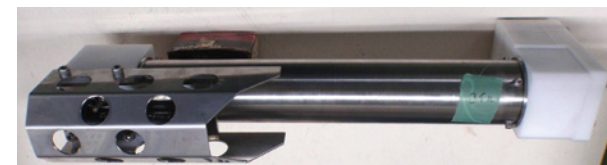
図15 JAMSTECオリジナル水中センサJES-10（IMタイプ）
