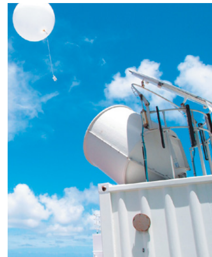
放球コンテナからのラジオゾンデ放球
