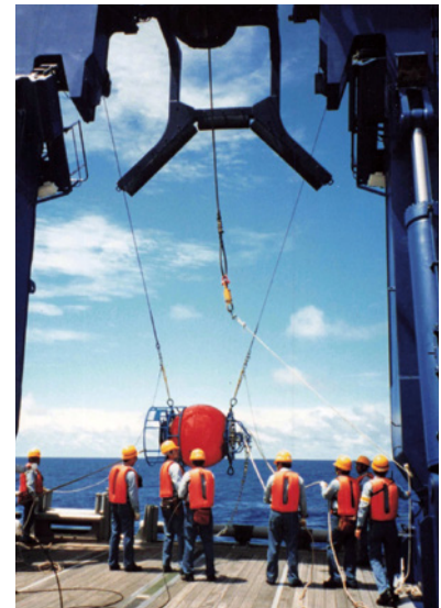
図2 MR00-K07 Leg 2での中層ADCP係留系の設置作業風景
