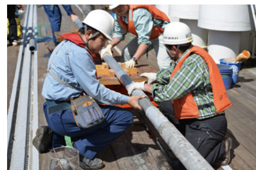
堆積物を採取し甲板に引き揚げた 20 mピストンコアラー
