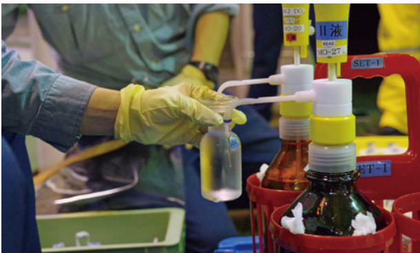
MR15-01航海での溶 存酸素試料への固定 試薬の分注
