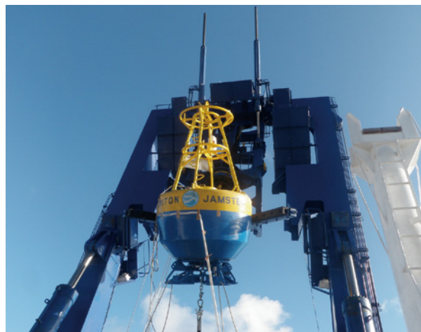
図11 「みらい」AフレームクレーンとTRITONブイ
