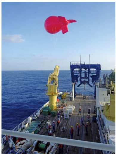
図4 上甲板から放球された係留気球。気球の下に観測装置を吊り下げ、上空のデータ・上空までの大気データを取得する。
