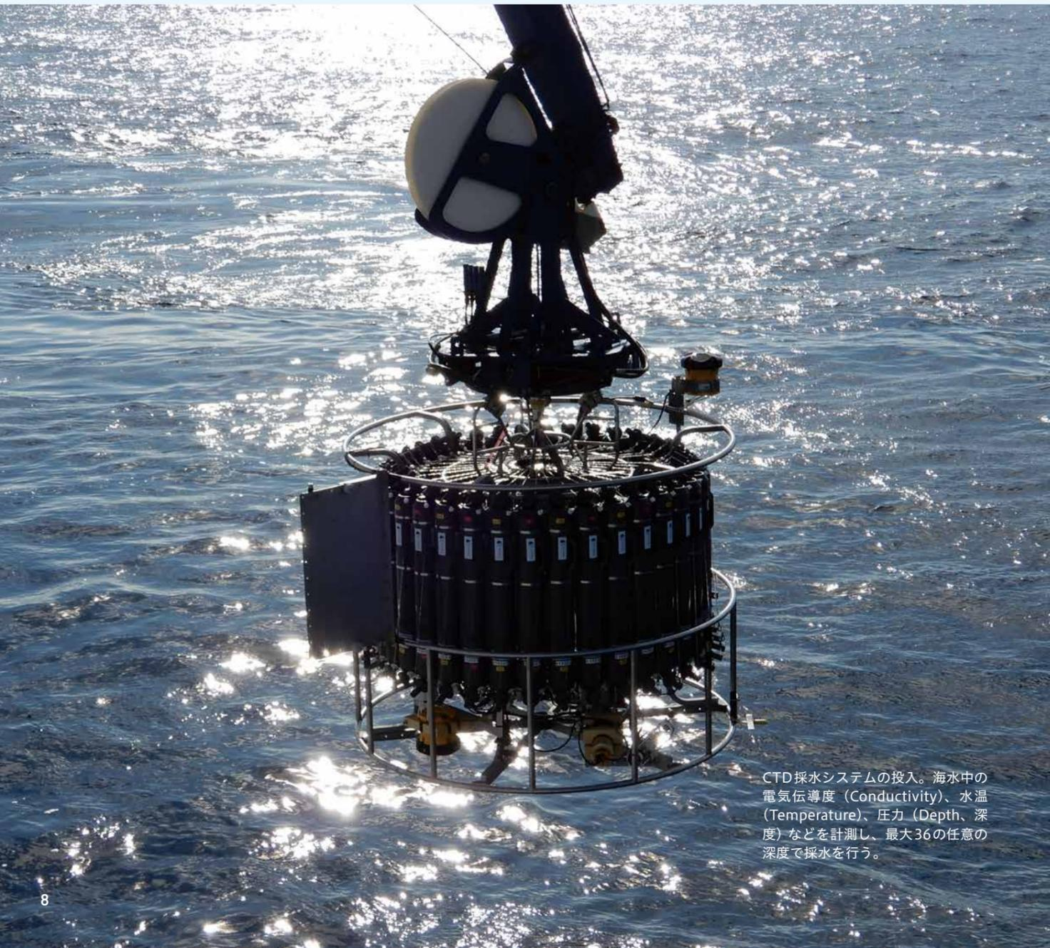
CTD採水システムの投入。海水中の電気伝導度 (Conductivity)、水温 (Temperature)、圧力 (Depth、深度)などを計測し、最大36の任意の深度で採水を行う。
