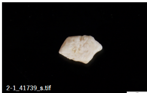
破片、ポリエチレン(PE) スケールバー 2 mm
