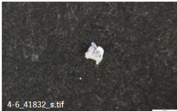
破片、ポリスチレン(PS) スケールバー 500 \mu m
