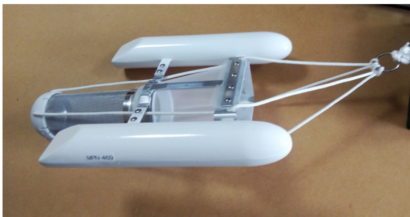
図 2. ヨット用に開発したマイクロプラスチックサンプリング装置（写真提供 沢地 繁）。
