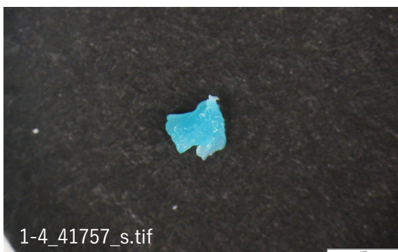
破片、ポリエチレン(PE) スケールバー 1 mm
