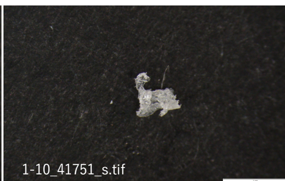
破片、ポリプロピレン(PP) スケールバー 1 mm
