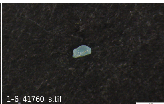
破片、ポリエチレン(PE) スケールバー 500 \mu m
