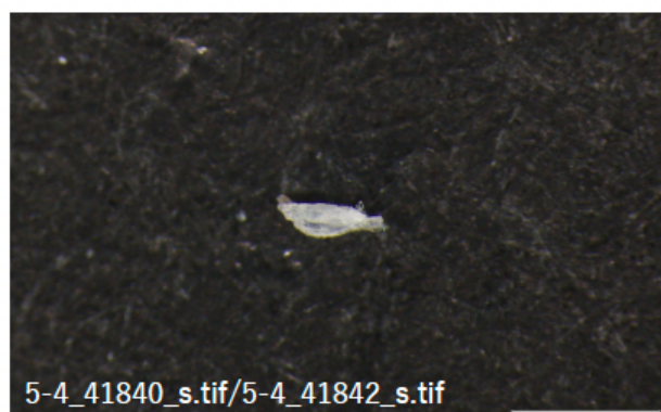
破片、ポリスチレン(PS) スケールバー 500 \mu\text{m}
