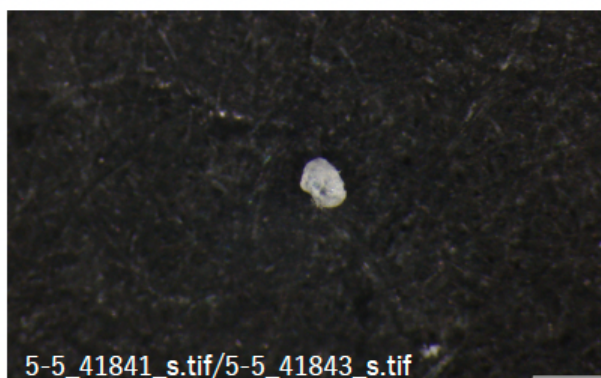
破片、ポリスチレン(PS) スケールバー 200 \mu\text{m}
