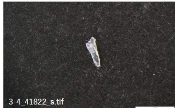
破片、ポリスチレン(PS) スケールバー 1 mm
