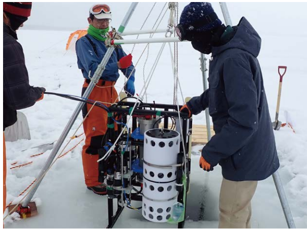
サロマ湖での電磁波を用いた 氷上と海中間のセンサデータ伝送試験
