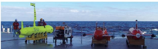
※ AUV: Autonomous Underwater Vehicle(自律型無人探査機)
