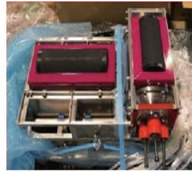
海洋鉱物資源調査・開発では、海底での無人探査機による作業を伴います。海底の表層堆積物の粒子は非常に細かく舞い上がりやすいため、このような懸濁域でも継続した作業が求められます。そこで、作業時の濁りにも左右されず、効率的な海底調査作業を可能とするために、音響を使ったビデオカメラを開発します。これまでに、港湾施設での3D映像の取得に成功しました。
