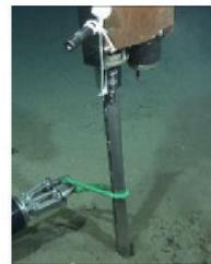
海底下の熱水成分等の分布は、潜頭性熱水鉱床の萌芽可能域推定の有効な指標の1つとなると想定されています。海底下の物理化学観測ならびに熱水採取を効率的に実施する機器を開発します。ROVで運用するPileBunker、および船上から打ち込む5m級SpearHeadの運用試験に成功しました。
