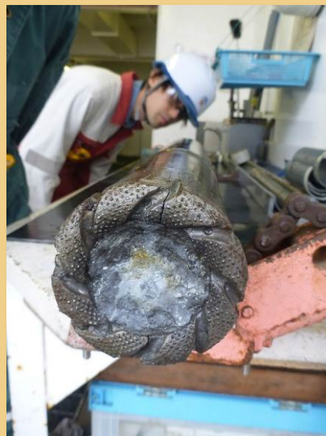
CK16-01航海では、ドリルパイプに変質岩が詰まり掘削が難航した。
