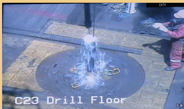
ドリル・パイプからリグフロアに溢れる熱水。海底下の帽岩（キャップロック）を貫いた（CK16-01航海）。
