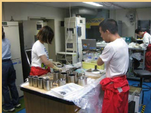
船上での間隙水の絞り出しのための作業（CK14-04航海）。
