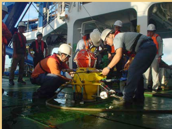
JAMSTEC研究者による自己浮上電位計（OBE）のセッティングをJAMSA技術者が見学している。YK16-12航海（2016年9月）。
