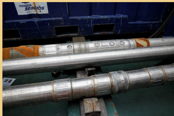
掘削同時検層(LWD)では、ドリルパイプ先端付近にセンサーを装着して掘削する(CK16-01航海)。
