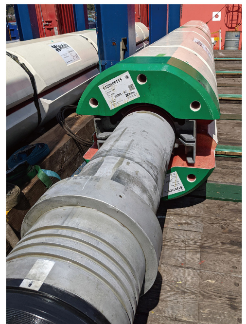
浮力体取付後のMerlinライザー
