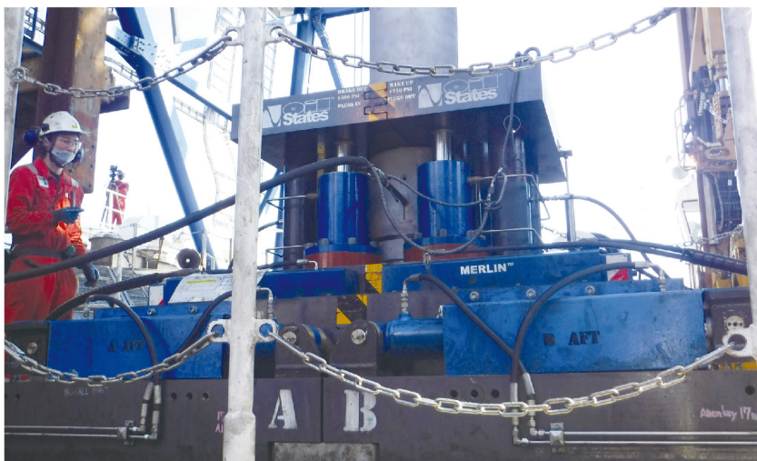
図3 Merlinライザーは油圧ホース(中央)を接続し、圧力かけるだけで嵌合できる
