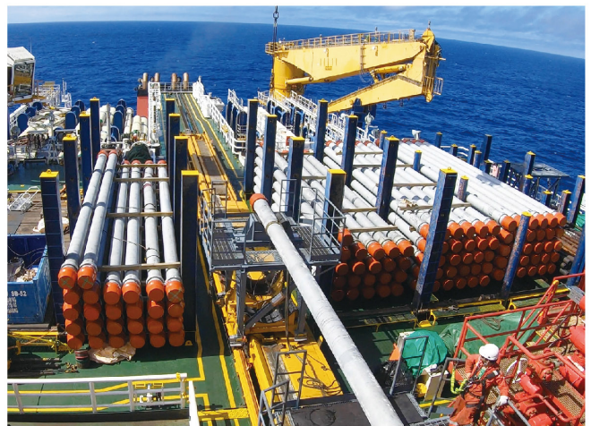
図1 新規納入したMerlinライザー
