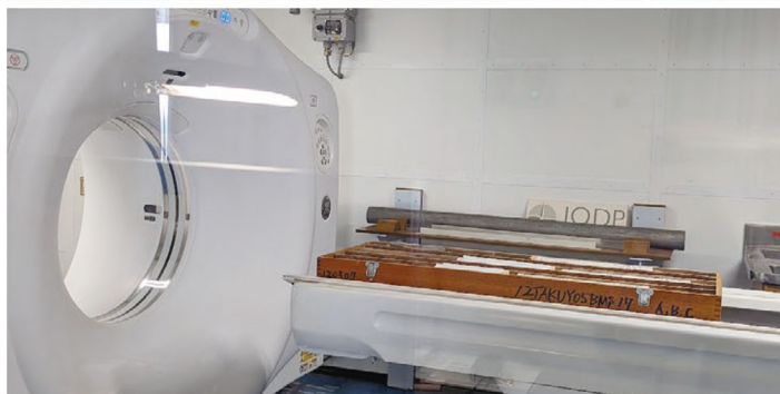
(写真1：左上)「ちきゅう」船上のラボに並べられたクラストコア試料 (写真2：右上) サンプルングをする研究者たち (写真3：左下) クラストコア試料を「ちきゅう」船上のX線CTスキャンにかける様子 (写真4：右下) 岩石サンプルを切断する様子
