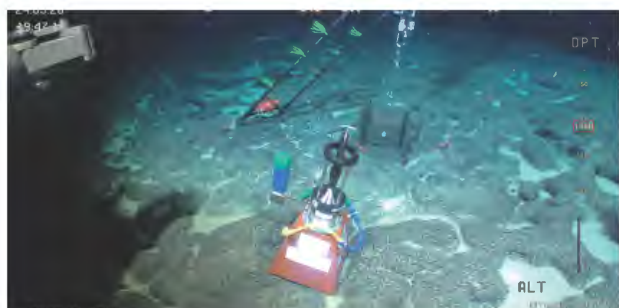
【「江戸っ子1号」の近くに設置したハイドロフォン】 KM-ROVにより撮影
