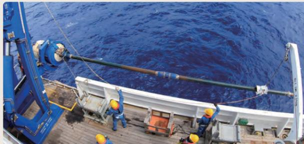
海底堆積層を採取するジャイアント・ピストン・コアラ (GPC)
