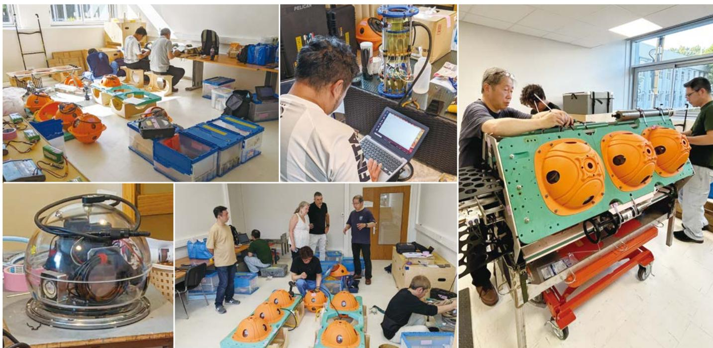
ニューカレドニアに到着後、日本から輸送した機材を取り出し、バッテリーを並べて充電、環境DNA採集装置の調整、ガラス球にカメラを組み込み、江戸っ子1号のユニットを組み立てる。
