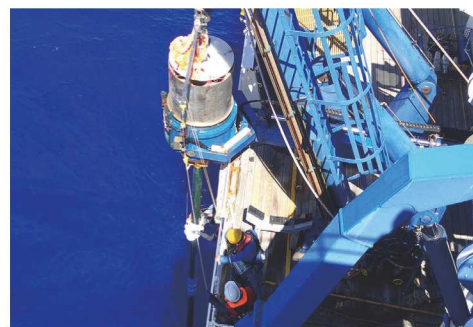
海底の堆積物を採取するジャイアントピストンコアの準備（2021 年の航海）
