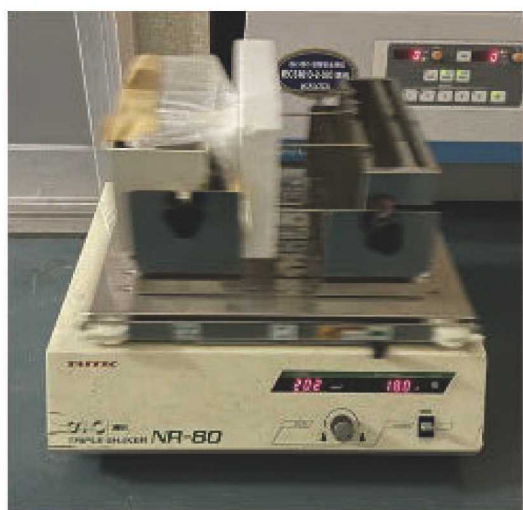
振盪装置による振動で溶出液を調製
