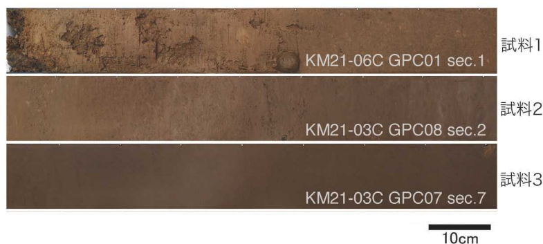
試験に使用したレアアース泥を含むコア試料
