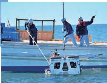
AUV「ほばりん」を漁船のクレーンで着水
