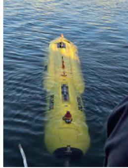
「しんりゅう 6000」は、潜航後に事前に入力した下図のような航路に沿って航走し、海底下 40cm に埋設されたパイプラインの位置と埋設深度を検知しました。海底から 20m の高度を維持しながら、途中、自律浮上し、GPS による位置確認をし、再度、パイプライン調査のために潜航するという自律制御のもとで、今回新たに、準天頂衛星「みちびき」を利用した SSBL 方式による AUV の測位にも成功し、より汎用的な測位方法を実証できました。
