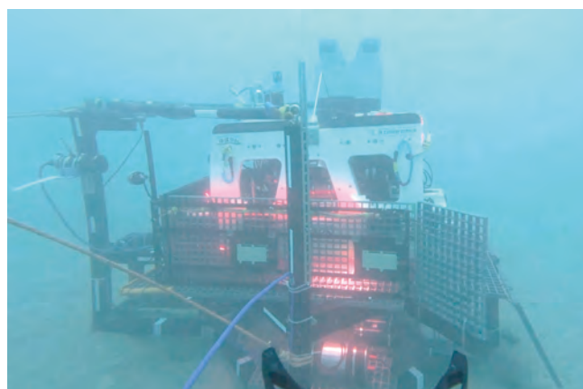
【沖縄県久高島沖でのドッキング試験状況】 （「ほぼりん」が深海ターミナル上に着座）
