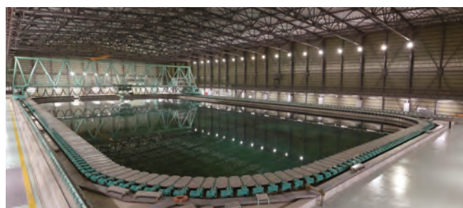
【事前確認試験を実施した NMRI 実海域再現水槽】
