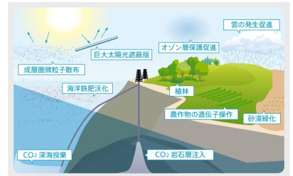
提案されているジオエンジニアリングの手法。創生プログラムではこのうち「成層圏微粒子散布」と「海洋鉄肥活化」の現実性検証に取り組みます。
