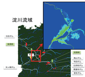
図3: 淀川流域における流出氾濫シミュレーション
