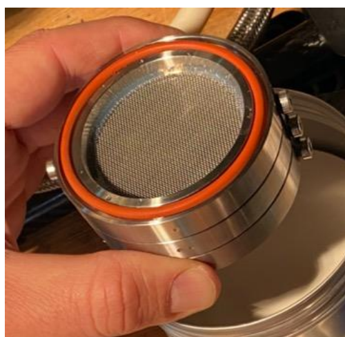
図5 MP サンプラーの3連フィルターユニット。海水中のマイクロプラスチックは、上から 300, 100, 30 \mu m 目合のフィルター上に順々に捕集される。
