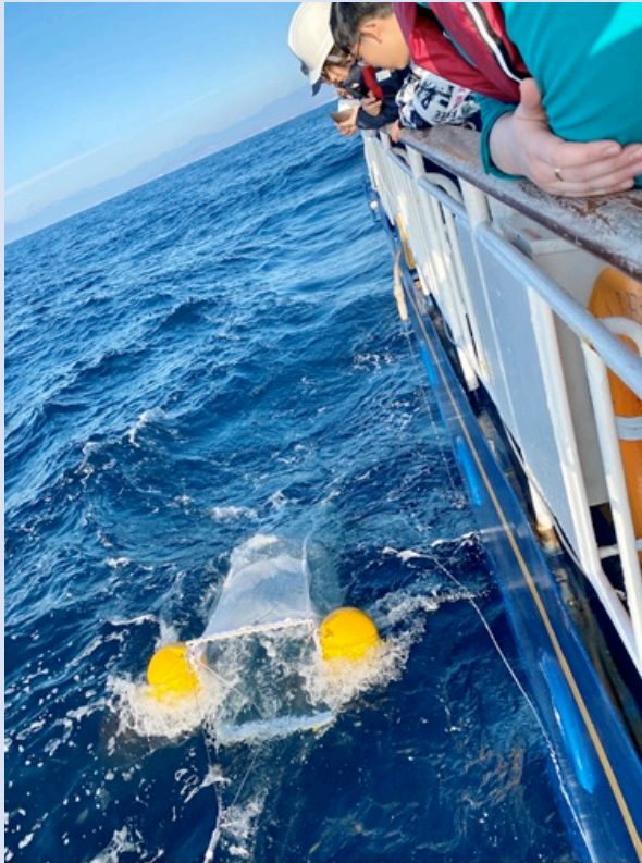
図3（左）「みらいへ」でのニューストンネットによる観測の様子。（右上）パラオ沿岸で採集された有機物が混入するサンプル。（右下）沖合観測点で採集された、サンプル。青色や白色のマイクロプラスチックが目視できる。
