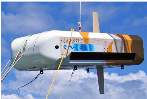
中性浮力曳航体を用いた合成開口ソナーシステム「響竜」
