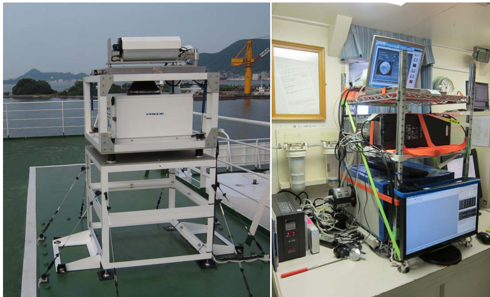
図 1. 「みらい」における MAX-DOAS 観測システム (左: 屋外太陽光受光ユニット (アクティブ型ジンバル、架台を含む)、右: 室内分光器ユニットおよびデータ解析用コンピューター)
