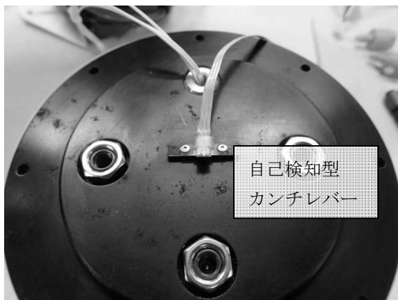
図 1. パリレン樹脂でコーティングしたカンチレバー
