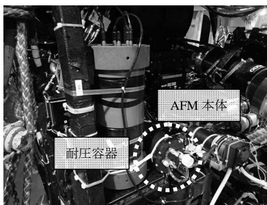
図 3. ハイパードルフィンに搭載した海中 AFM
