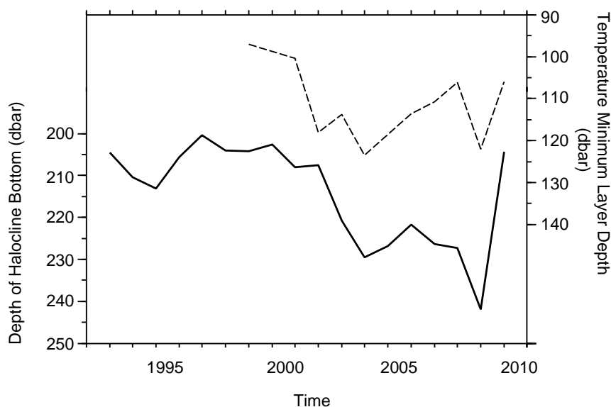
図 2. WSAG の変動に伴う K2 に於ける塩分躍層底面の深さの時系列(実線)と現場 CTD データと Argo データより Wakita et al. (2010, 2013) の手法を用いて検出した水温極小層の深さの時系列(破線)。
