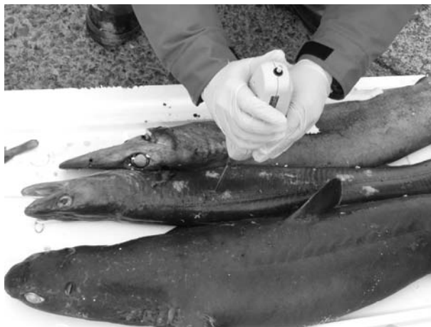
フォースゲージを用いた表皮の貫入圧計測試験
