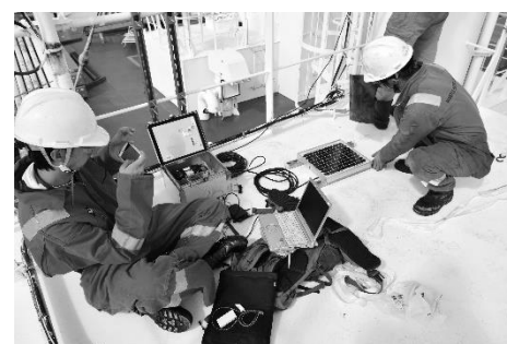
図1. (左) GNSS-R アンテナの取付作業，(中) ROV への TD センサー取付作業，(右) 気象センサーの取付作業．(2018年9月11日「ちきゅう」清水港停泊期間中に実施)
